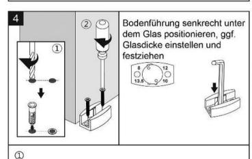
Bohrlöcher anzeichnen und bohren, Dübel einsetzen und mit Schrauben 4.8\*35mm festziehen
