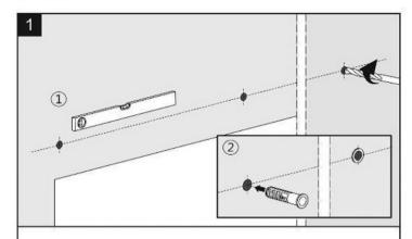
Bohrlöcher gemäß Höhe H1 anzeichnen und bohren Dübel ggf, durch bauseits passende ersetzen, die Wand muss plan und tragfähig sein
