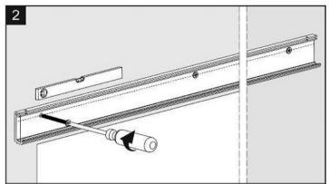
Schraube 11 mit Schraubendreher eindrehen und festziehen. Auf Verwerfungen der Laufschiene achten und ggf. unterfüttern
