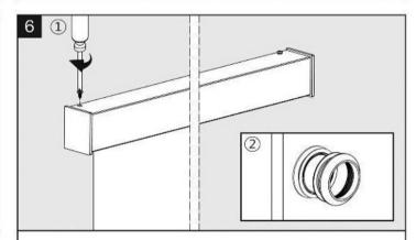
Endkappen aufstecken und mit Schraube 3\*8 mm festziehen, Griffmuschel oder Stossgriff jeweils mit Unterlage-Pads montieren
