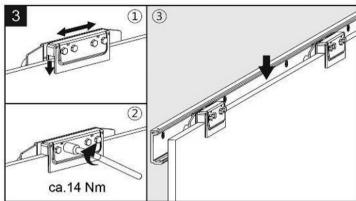
Glas-Pads ca. 10 cm von der Glaskante U-förmig über das Glas legen Laufwagen darüber stülpen, Glas darf nicht mit Metall in Berührung kommen zwischen Oberkante-Glas und Klemmbacke 1 mm Abstand lassen mit Werkzeug (ca. 14 Nm) anziehen in Schiene gleichmäßig einhängen
